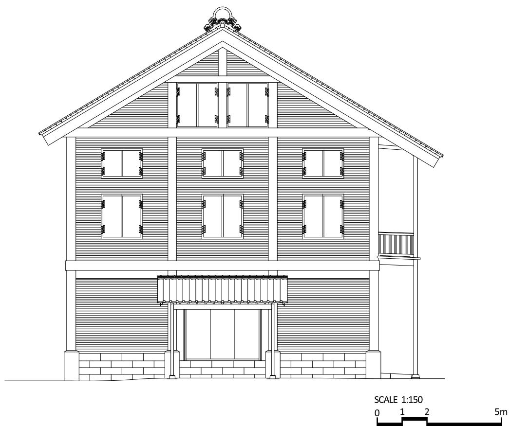
図 2-11 S1 富岡製糸場 東置繭所 北側立面図
