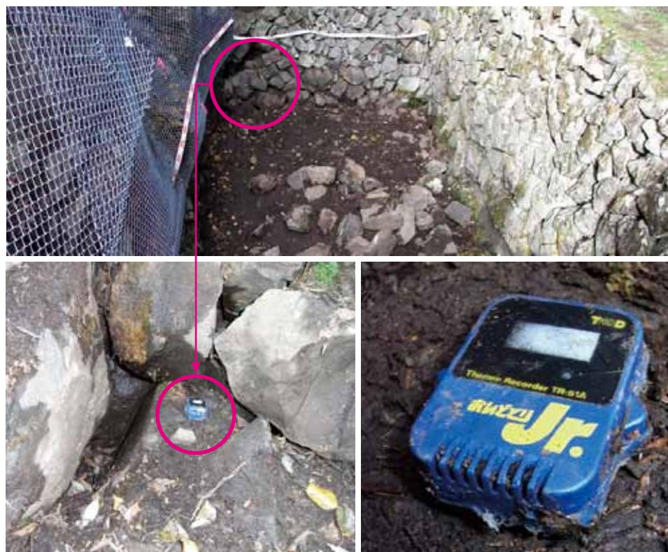
写真 6-1 荒船風穴に設置された温度管理のためのデータロガー。下仁田町。
